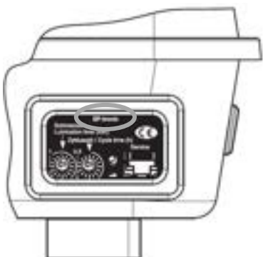
EP-tronic im Sichtfenster mit 2x Hirschmannsteckanschluss Gerät mit EP-tronic mit Hirschmannsteckanschluss Anschlussplan siehe Kapitel 7.2.7 zur Funktion siehe Kapitel 11.2 Signalanzeigen siehe Kapitel 15.3.2
