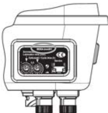
BEKA-troniX1 im Sichtfenster mit Bajonettsteckanschluss und M12x1 Steckanschlüssen Gerät mit BEKA-troniX1 Anschlussplan siehe Kapitel 7.2.5 zur Funktion siehe Kapitel 11.1 Signalanzeigen siehe Kapitel 15.3.1
