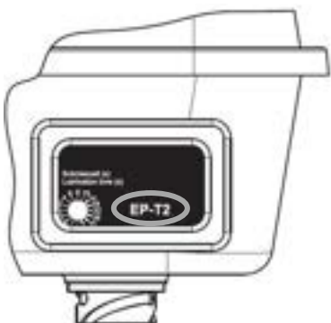
EP-T2 im Sichtfenster mit Bajonettsteckanschluss Gerät mit EP-T2 Anschlussplan siehe Kapitel 7.2.10 zur Funktion siehe Kapitel 11.4
