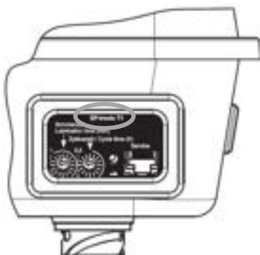
EP-tronic T1 im Sichtfenster mit Bajonettsteckanschluss Gerät mit EP-tronic T1 mit Bajonettsteckanschluss Anschlussplan siehe Kapitel 7.2.8 zur Funktion siehe Kapitel 11.3 Signalanzeigen siehe Kapitel 15.3.3
